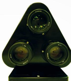
Fig. 1 Imagem do rotor com a hélice utilizada no ensaio (esquerda). Corpo da sonda com câmara tripla TSI V3V TSI-9000-TS (direita).
