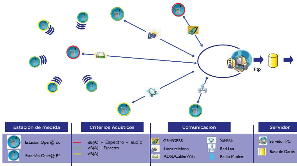
Como puede observarse en el esquema, una de las grandes ventajas del sistema Oper@ son las amplias posibilidades de conexión entre las estaciones de medida y el servidor central.
