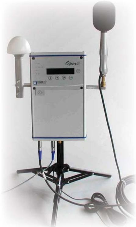
La estación Oper@-EX ha sido diseñada de tal forma que el impacto visual y sobre el mobiliario urbano sea mínimo. Además, la unidad es resistente a las agresiones climáticas (temperatura, lluvia, etc.) gracias a su grado de protección IP55.
