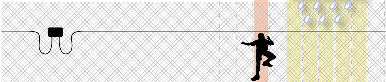
Cuando el blanco hace contacto con la cerca, la señal recibida se analiza para crear una firma que describa el pulso reflejado. El Procesamiento de Señal Digital (DSP) mide la ubicación y forma de este pulso. El microprocesador puede diferenciar la forma de una respuesta de un Impacto Puntual (intento de corte o de escalada) versus una respuesta causada por una Alteración Distribuida (lluvia, viento, tráfico de vehículos).
