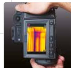
La orientación automática mantiene vertical los datos de pantalla.
