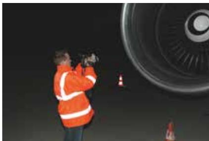
Inspección de un avión con una cámara termográfica.
