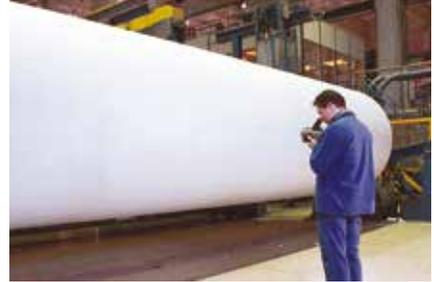
*Inspección de la distribución de la humedad de la inyección de la banda de papel, que pasa a una velocidad de 1600 metros por minuto.*
