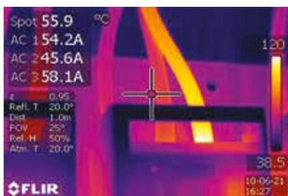
Gracias a que incorpora MeterLink, los valores registrados en las pinzas amperimétricas se muestran en la termografía.
