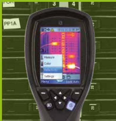
FLIR i3, temperatura en 3600 puntos
