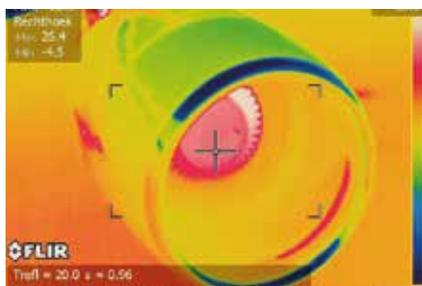
Termografía de un motor. Se requieren ciertos conocimientos para "interpretar" las termografías de un avión, ya que los diferentes materiales tienen emisiones distintas.
