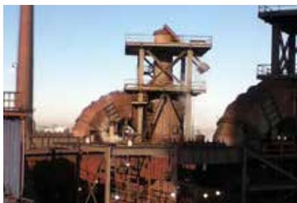
*Esta caldera se revisa semanalmente con una cámara termográfica para valorar las condiciones del revestimiento refractario.*
