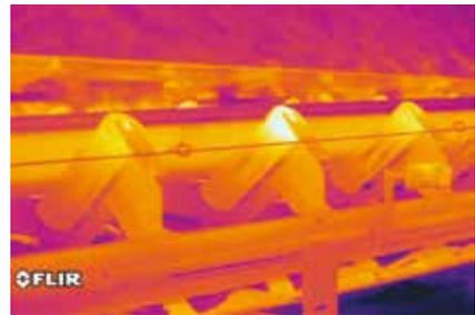
Imagen visual y termografía de los rodamientos de un rodillo sobrecalentado que deben sustituirse.
