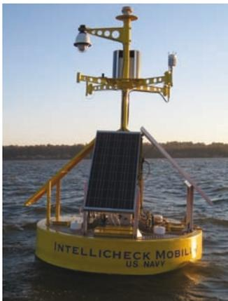
Existe una red de boyas con sensores de alta tecnología configurados con un array de sensores (de vídeo, acústicos, medioambientales, radiación, climáticos...) para la detección de riesgos de seguridad y medioambientales en puertos. Como complemento, el Discoverii se emplea para apuntar automáticamente al evento y como herramienta de evaluación por el personal de seguridad para monitorizar las boyas.
