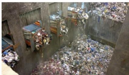
Los **algoritmos de detección de incendios** de las cámaras Sii y Accuracii protegen las vidas y ahorran dinero en las plantas de reciclaje de todo el mundo. Las cámaras permiten detectar los puntos de mayor temperatura y así alertar de una posible combustión en el material de capas inferiores. Las cámaras funcionan todo el día dando seguridad antiincendio y también de acceso a la planta cuando no está operativa.
