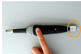
Encender la sonda inalámbrica. El indicador LED azul parpadeará indicando que la sonda está encendida.
