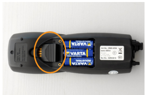
Insertar el módulo de radio para transmisión inalámbrica (0554 0188).
