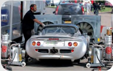
Medida de potencia de motor de automóvil sin necesidad de eslingas, fosos o rampas de acceso de vehículo a banco de rodillos tradicional. Precisión en medida de potencia y movilidad. ¿Un banco de rodillos transportable? Existe.
