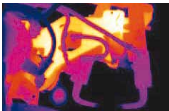
Punto caliente en robot de soldadura
