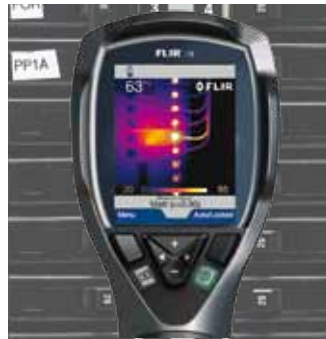
FLIR i3, temperatura en 3.600 puntos
