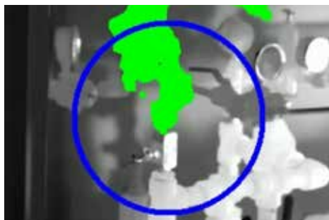
Cuantifica gases, como el metano que escapa por esta válvula de pozo a 0,59 lb/hr
